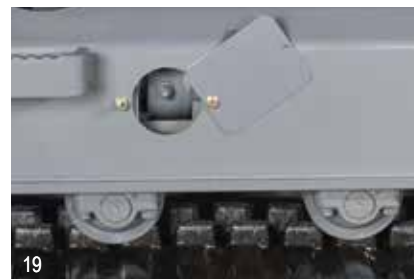
VOLLAUTOMATISCHE HYDRAULISCHE KETTENSCHNITTUNG
