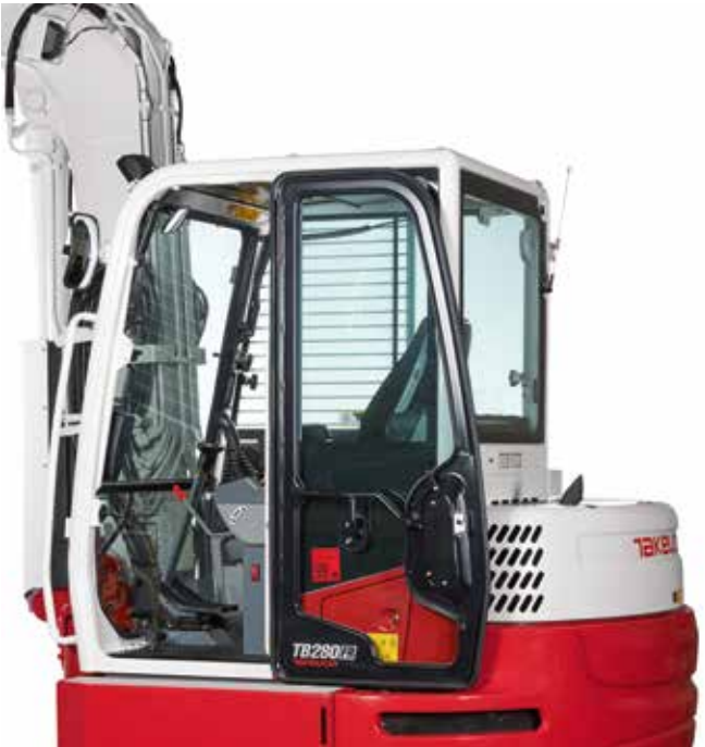
BREITER KABINENEINSTIEG UND EINZIEHBARE FRONTSCHIEBE
